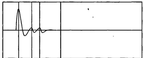
图4 桩身受荷后低应变测试曲线图
