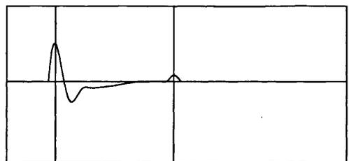
图5 完整桩低应变测试曲线图
