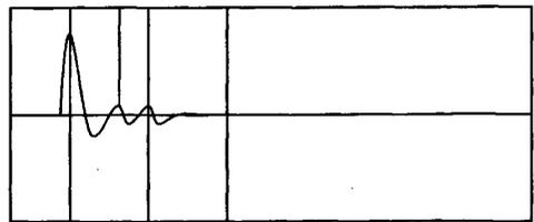
图 1 静载测试前低应变测试曲线图
