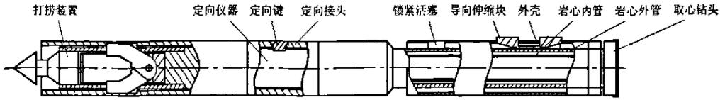
图 6 定向钻进绳索取心钻具结构图
