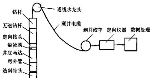
图2 有线随钻定向示意图
