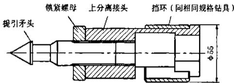
图1 组合式提引接头示意图
