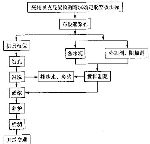
图 2 施工工艺流程图
