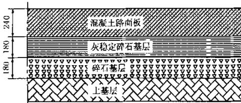
图1 路面结构示意图
