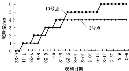
图3 5号和10号点沉降观测曲线(2004~2005)
