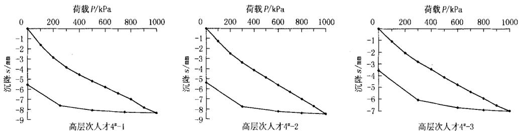
图2 砂卵石换填地基静力载荷试验 $P-s$ 曲线
