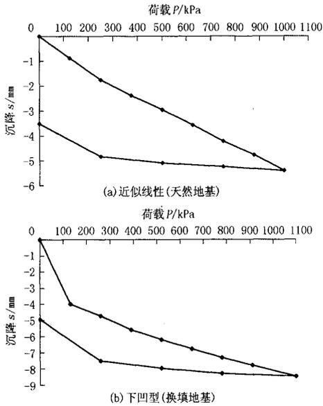
图 1 换填地基静力载荷试验 P-s 曲线
