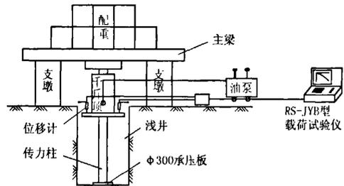
图1 岩基载荷试验示意图
