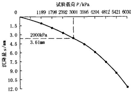
图 2 50 号试验点  $P-s$  曲线
