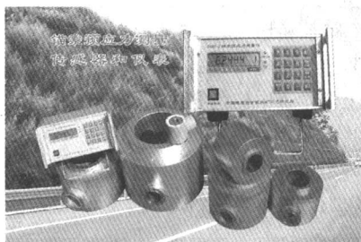
图7 BMS-2 型锚索预应力测量系统
