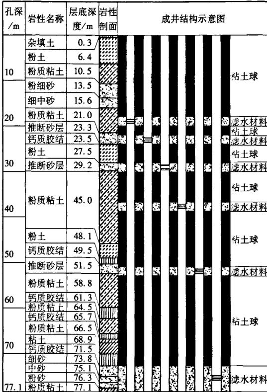
图10 连续多通道成井结构示意图
