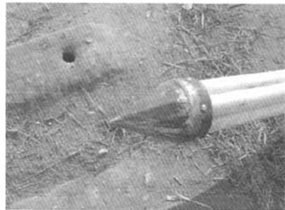
图4 连续多通道管导正尖
