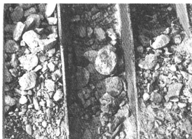
图 5 反循环钻进取出的岩矿心
