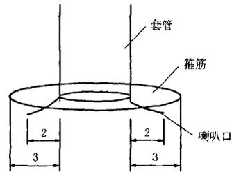
图 1 套管底部喇叭口示意图
