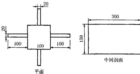
图2 人工孔口示意图
