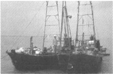
图 1 单体船侧跨式施工平台
