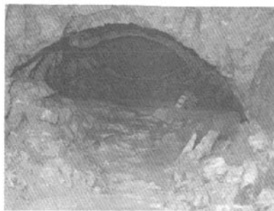
图 2 某地岩石非开挖钻孔中钻屑充填截面图
