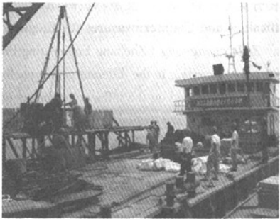
图 3 自航式船侧伸出式单体钻探船
