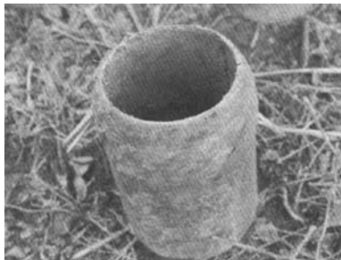
图1 磨损割断的扩孔器
