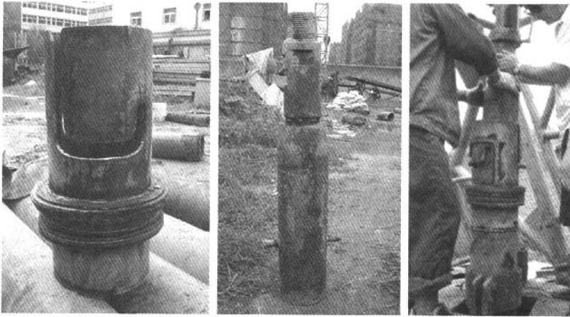
图5 PVC-U 塑料管井破碎爆裂事故处理中采用的补管上端密封装置和挂口
