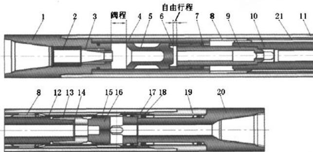
、图1 YZX 系列高效液动潜孔锤结构示意图
