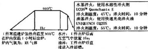
图2 热处理试验条件
