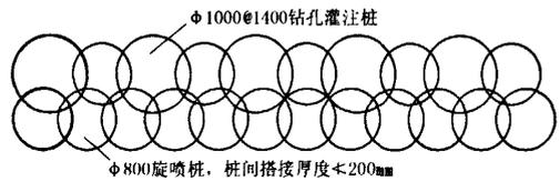
图2 咬合旋喷桩止水帷幕平面布置图
