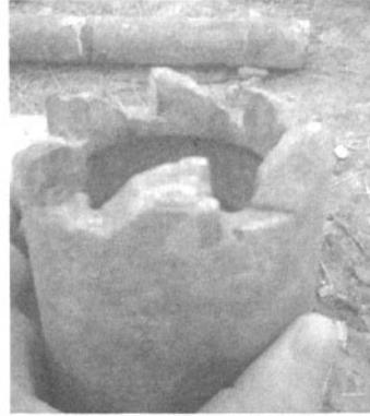
图6 新型复合片钻头实物
