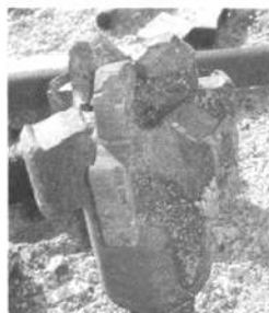
图2 严重磨损的刮刀钻头
