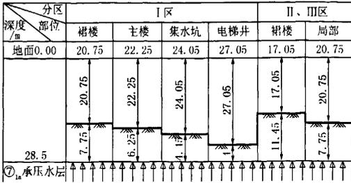
图4 基坑各部位开挖深度与承压含水层的关系示意图
