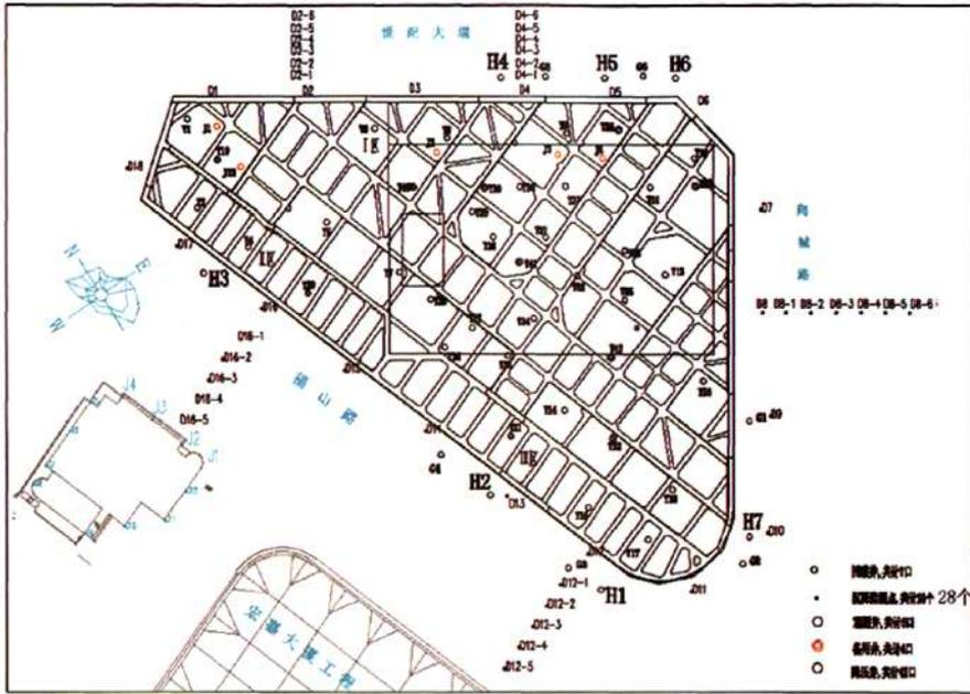
图6 基坑降水井及监测点平面布置图
