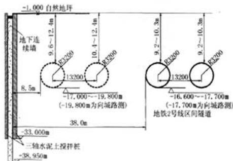
图3 基坑与地铁2、9号线隧道关系剖面示意图
