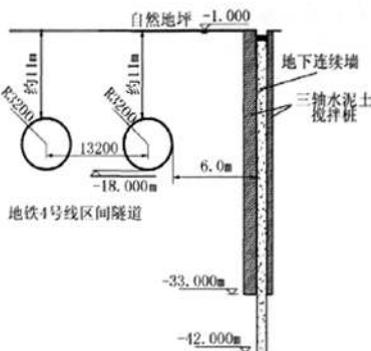
图2 基坑与地铁4号线隧道关系剖面示意图
