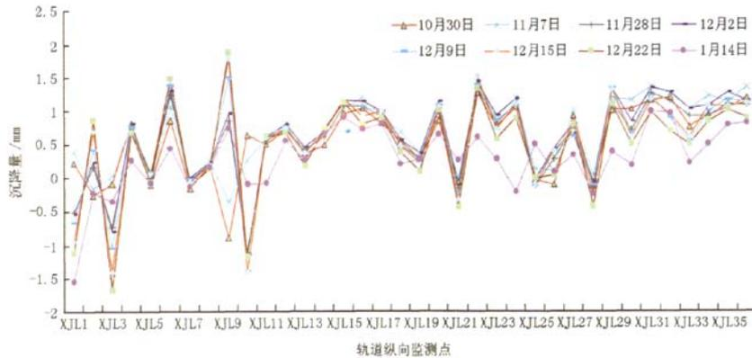
图14 地铁4号线轨道沉降变化曲线
