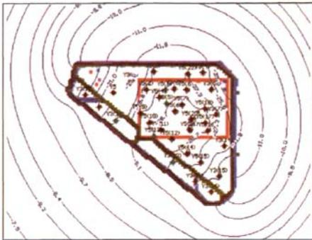
图 8 开挖施工基坑降水 30 天后承压水位埋深等值线图 (单位:m)
