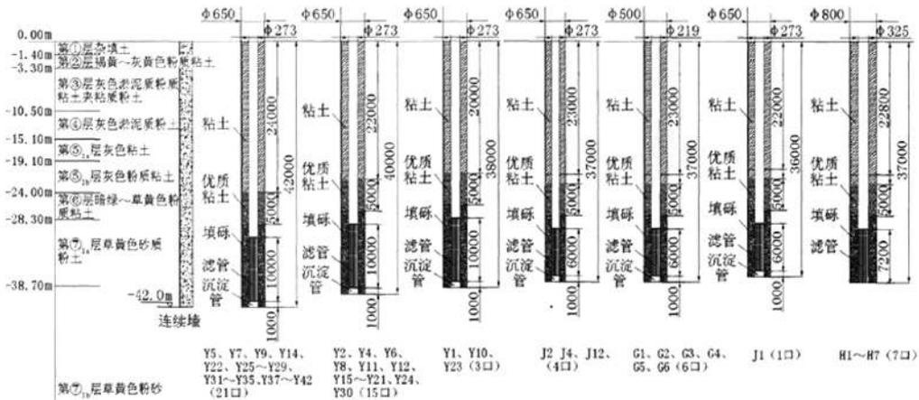
图7 基坑降水井剖面示意图
