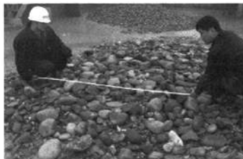
图2 宜昌盾构施工中从江底取出的卵石
