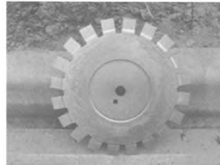
图2 Ø350 mm 整体式锯片(R=6 mm)
