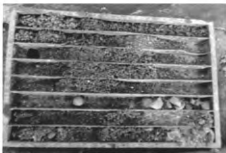
图3 ZK1903号钻孔捞砂器捞起的钻渣照片
