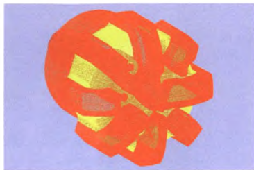
图5 低温电铸孕镶脉冲石油钻头网格示意图
