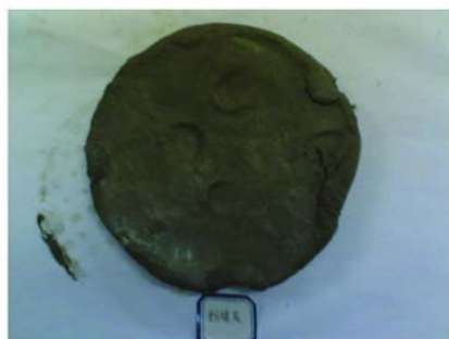
图 5 加粉煤灰废泥浆压榨过滤后滤饼
