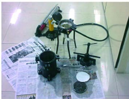
图 1 室内自制废泥浆压榨过滤装置
