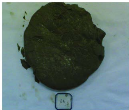
图 4 加石灰废泥浆压榨过滤后滤饼
