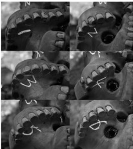
图 3 U613M 六刀翼详细磨损情况
