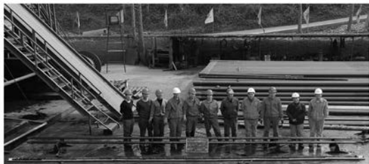
图4 采用9 m长半合管取心钻具获取的连续无扰动的长岩心
