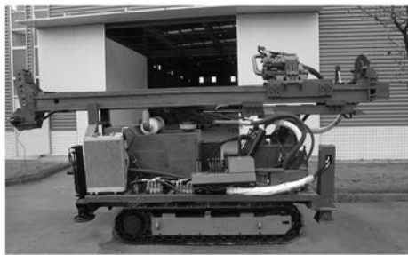
图 1 GDZ-300L 型钻机外形图
