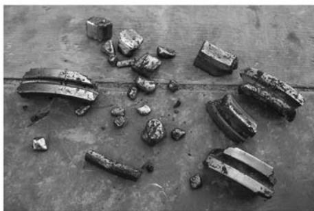
(b) 打捞上的孔底其它金属落物
