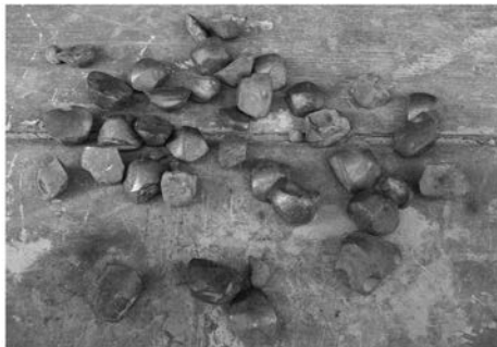
(a) 打捞上的钻头脱落合金
