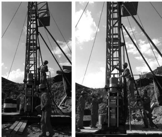
图3 机上打捞内管总成
