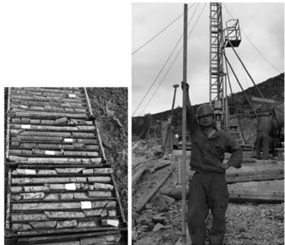
图5 试验取出的岩心样品
