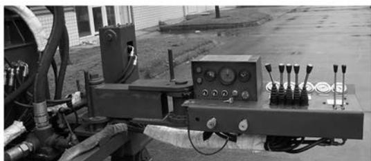
图3 GDZ-300L型钻机钻进控制台外形图
