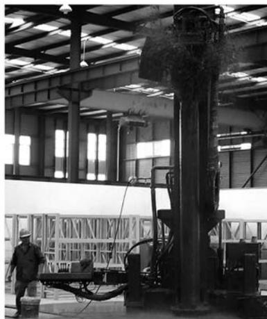
图4  $\varnothing 273$  mm套管空气潜孔锤跟管钻进试验现场
