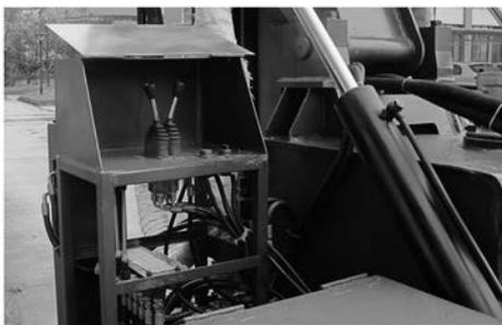
图2 GDZ-300L型钻机行走、就位操控台外形图
