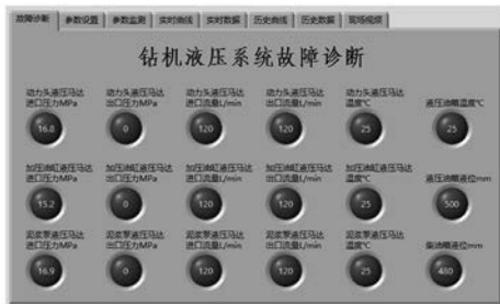
图3 钻机液压系统故障诊断程序界面
