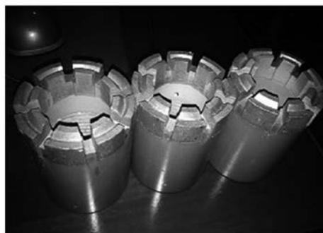
图1 高效长寿命孕镶金刚石阶梯钻头
