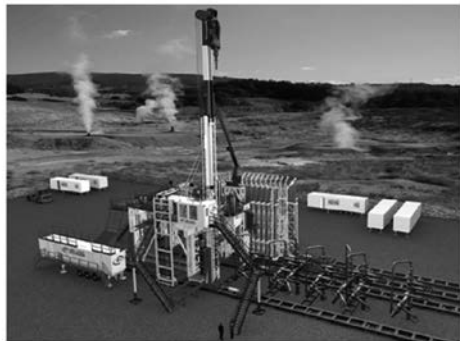
图 2 带平移轨道的可移动液压钻机
