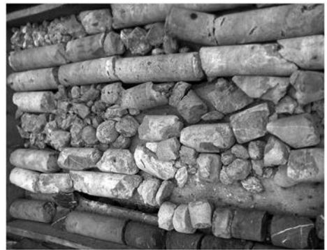
图3 岩心从破碎到完整过渡照片
