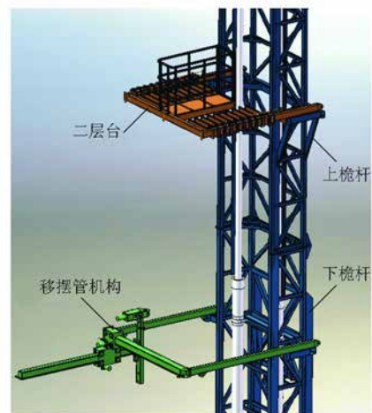
图1 3500 m 岩心钻机局部示意图
