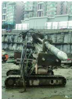
图3 PDH-130 型旋冲挤密 矛头试验现场
