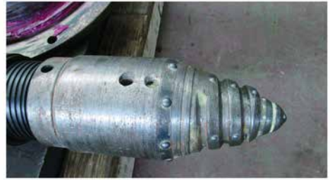
图4 试验用单头螺旋冲击矛头
