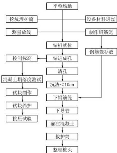
图 3 钻孔灌注桩施工流程图
