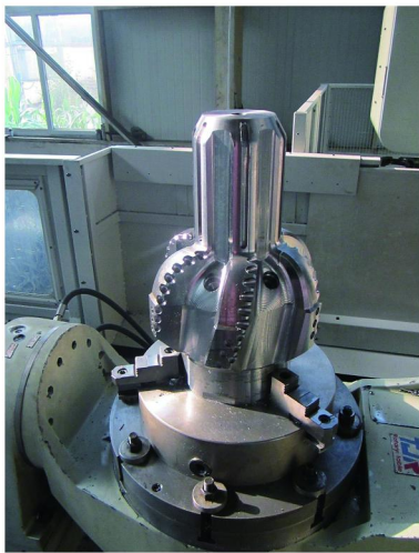
图 19 钻头钢体数控加工过程
