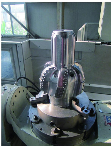
图 19 钻头钢体数控加工过程
