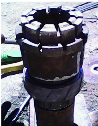
图3 西藏科钻自制增环隙钻头
