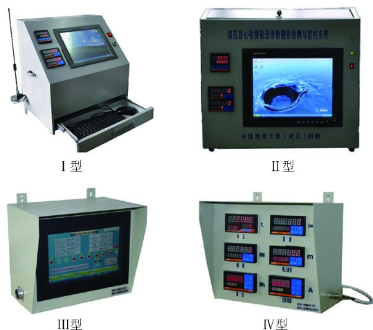
图 4 深部探测项目配套的 4 种不同地表钻参系统
