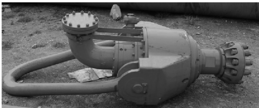
图 5 气举反循环送水器
