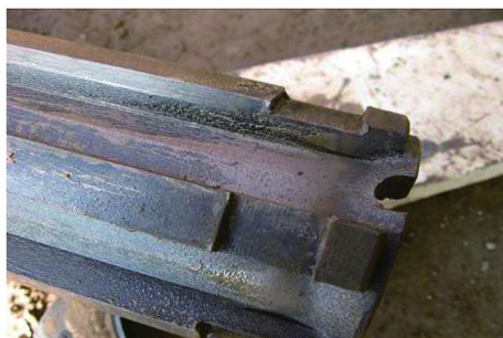
图 11 钻进 60 m 后的改进钻头尾部
