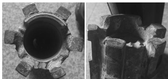
图 1 通体花键式反循环钻头尾部破损情况
