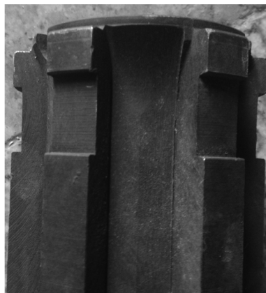
图 4 带倒角反循环钻头尾部实物
