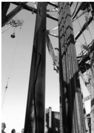
图 4 成螺旋状破裂的套管
