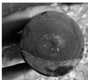
图 11 造斜及稳斜取出岩石(水泥)心
