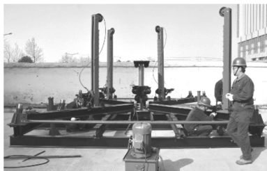
图1 安装底盘和地面安拆装置
