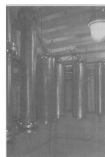
(b) 对所得含纳米金刚石粉料进行热力氧化处理的反应堆设备
