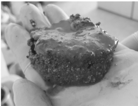
图 2 高渗透性漏失封堵效果图
