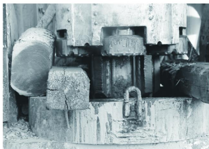
图2 潜孔锤孔口测试
