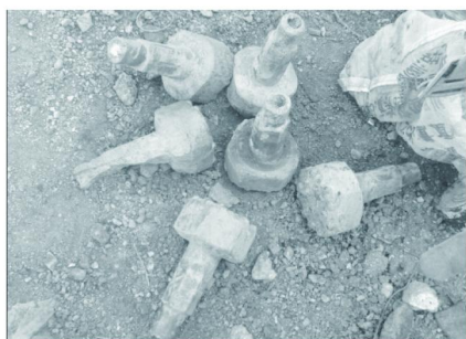
图3 被打捞上来的掉落孔内的子锤
