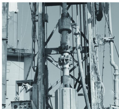
图7 2套气路、注气旁通阀和控制阀
